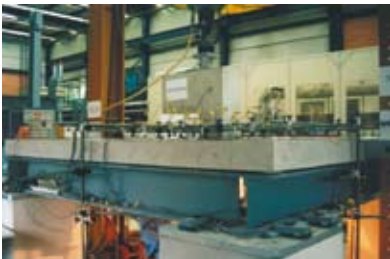
Durchstanzversuche EPFL Lausanne (2000) Essais de poinçonnement EPFL Lausanne
