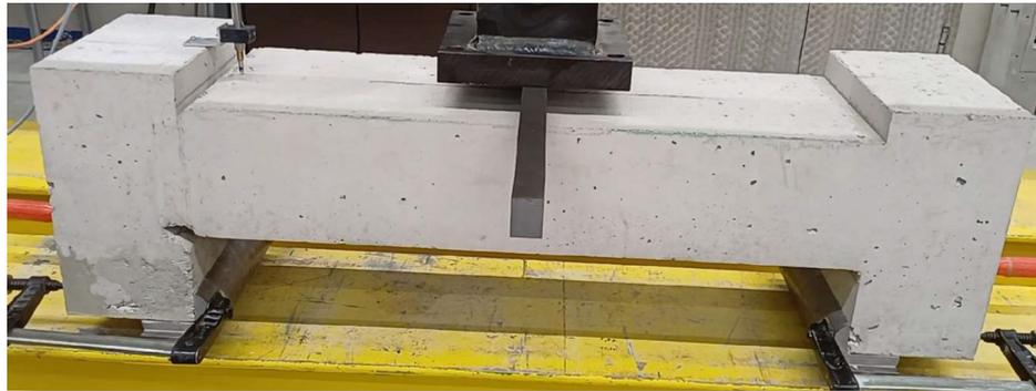
Beispiel eines Versuchs-Details für COMAX®-X
